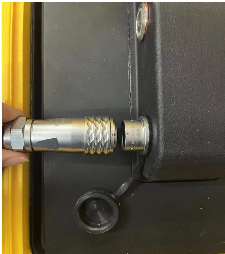
图 2.1.7 换能器缆线插拔示意
