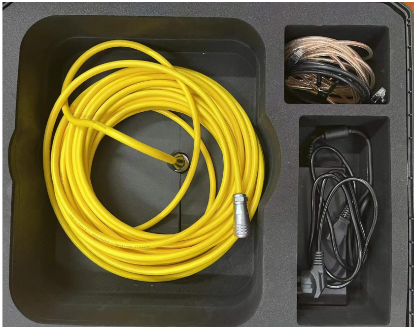
图 2.1.4 GeoScope-100 换能器，适配器，网线，接地线等装箱
